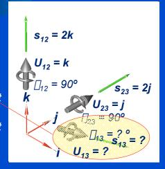
$$\begin{bmatrix} B_{13} \end{bmatrix} = \begin{bmatrix} B_{23} \end{bmatrix} \begin{bmatrix} B_{12} \end{bmatrix}$$
