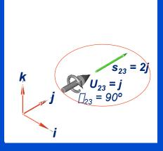
$$\begin{bmatrix} R_{13} \end{bmatrix} = \begin{bmatrix} R_{23} \end{bmatrix} \begin{bmatrix} R_{12} \end{bmatrix}$$
